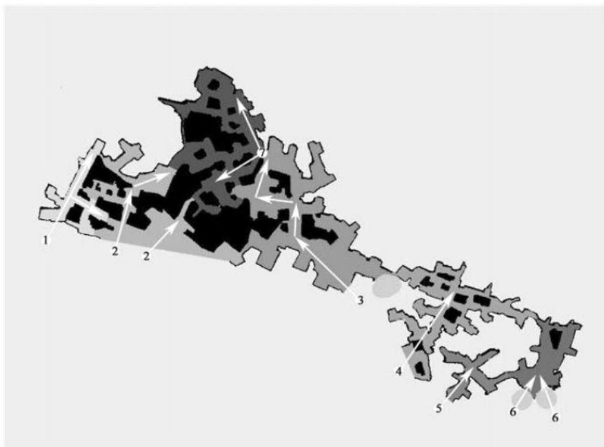
Figuur 1: Ontginningsstadia en graafrichtingenkaart van de Studentengroeve, Koepelgroeve en het Bergske van Rosalie. Dit is een schoolvoorbeeld van een zogenaamde 'lintontginning' waarbij meerdere kleine ontginningen uiteindelijk aan elkaar gegroeid zijn. Veldwerk auteur 2001. Maker kaart onbekend. Samengesteld door Ed Stevenhagen.
